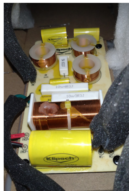
Klipschin jakosuodin sisältää runsaasti tavaraa. Diskantin tasoa olisi voinut vaimentaa suodattimessa enemmänkin.
