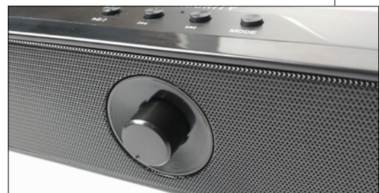
Majorityssä perinteinen pyörítettävä äänenvoimakkuussäädin, missä samassa myös virtakytkin.
