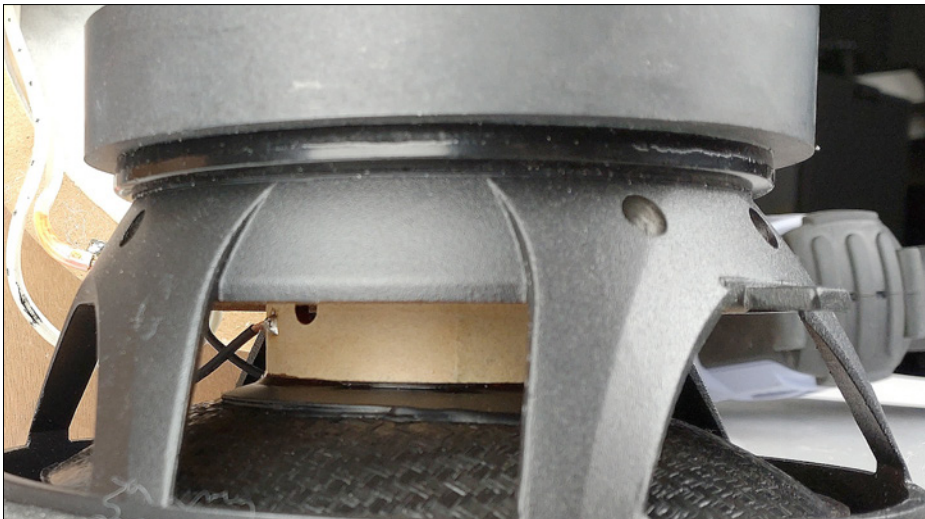
Audio Amatomyssä käytetään järeää 165 mm hiilikuitupunoksesta valmistettua basso-keskiäänielementtiä. Siinä on harvinaisen iso puhela.
