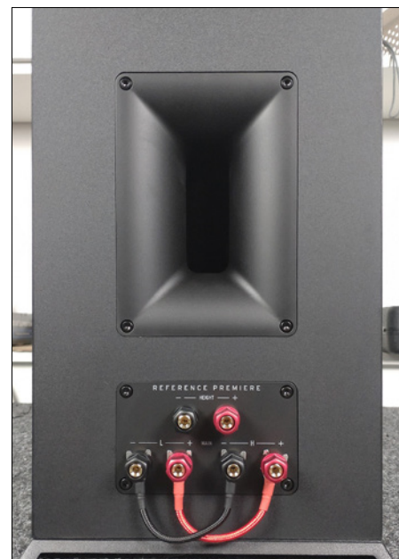
Kotelo on refleksiviriteinen ja toteutettu tässä suorakaiteen muotoisilla refleksiaukoilla/tunneleilla, joissa on myös torvimaiset päät. Naparuuviliittimet ovat laadukkaat ja mahdollistavat bi-wire- tai bi-amp-kytkennän. Erikoisuutena liitinpaneelissa liitäntä Atmos-korkeuslisäkaiuttimille ja niille kytkentäpisteet kotelon yläreunassa.
