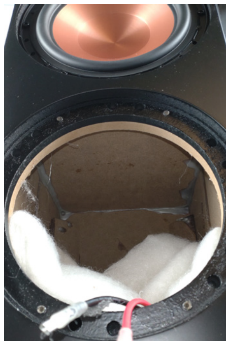
Klipschin kotelo on jaettu välilapiolla kahteen erilliseen kotelo-osioon, joissa kummassakin oma refleksiaukko.
