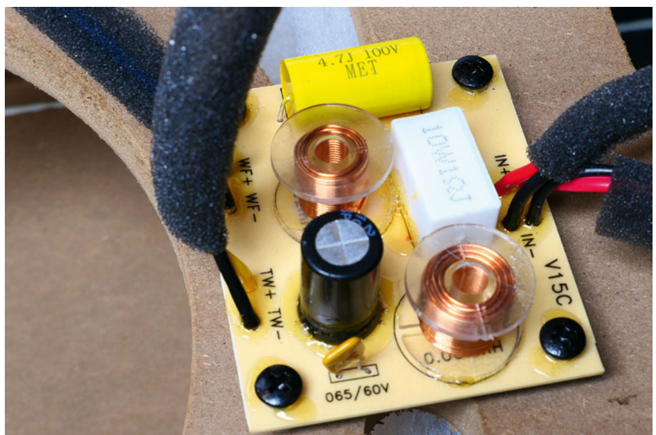
V15C:ssä (alempi kuva) bassokeskiäänelle ei ole sähköistä alipäästösuoatusta, vaan sen toiston annetaan vaimentua luonnollisesti. Diskantille on hieman erikoisempi, ikään kuin kaksivaiheinen 1. asteen ylipäästö. Myös 12-tuumaisen (ylempi kuva) diskantille on sama suodatus, mutta bassokeskiäänelle on tässä jyrkempi 2. asteen alipäästösuoatusta. Tästä saattaa myös johtua toistovasteessa havaittu vaimentuma jakotaajuuden kohdalla.
