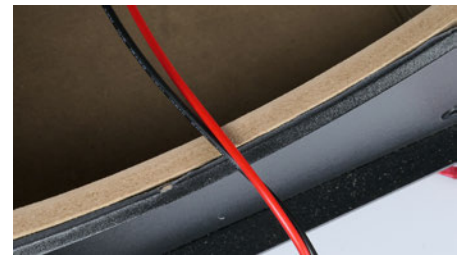
Kevyt rakenne jatkuu Fentonin kotelossa. Se on subbarikäyttöön aivan liian ohutta levyä.
