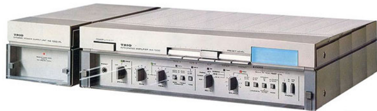
Kenwood esitteli upeassa KA-1000 integroidussa vahvistimessa (myös KA-900 ja KA-800 Sigma-Drive-tekniikan vuonna 1981. Sigma-Drive on negatiivisen takaisinkytkennän järjestelmä, joka ulottuu aina kaiuttimien liitäntöihin saakka. Tämä mahdollistaa kaiutinkaapeleiden ja kaiuttimien itsensä aiheuttamien särötuotteiden palauttamisen vahvistimen takaisinkytkentäsilmutkaan, mikä parantaa kaiuttimien kontrollia.
