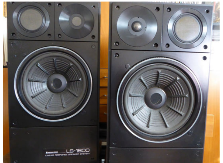
Kenwoodin "Linear Response" kaiutinmallisto oli myynnissä vuosina 1981-83. Kuvassa malli LS-1800. Kaiuttimien erikoisuus oli keskiääni- ja diskanttielementtien tasokartiot ja erillinen Sigma-Drive-liitäntä joka oli Kenwoodin joidenkin vahvistimien erikoisuus.
