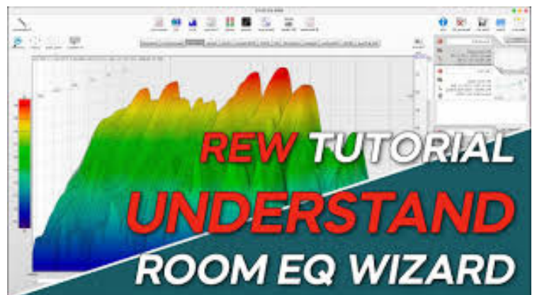
Room EQ Wizard (REW) on ilmainen PC-ohjelma joka mahdollistaa taajuusvasteen, huonemoodien, heijastusten ja jälkikaiunnan mittaamisen. Se on erittäin monipuolinen (lue: myös monimutkainen) ohjelma, joka tosin vaatii niin ohjelman opettelemista kuin sen antamien mittausten tulkintaa, mutta antaa vastineeksi todella paljon tietoa. Ohjelma on ladattavissa täältä ja se käytöstä on täällä hyvä Youtube-soittolista.
