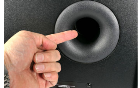
Fentonissa on halkaisijaltaan käsittämättömän pieni refleksiputki. Itse asiassa voiko sitä edes tavalliseksi refleksiputkeksi kutsua, koska emme saaneet siitä irti mitään järkevää viritystaajuutta. Viritystaajuus on jossain 20 hertsissä? Aukko on enemmänkin kuin jonkinlainen "venttiili", joka alkaa jarruttamaan ilman virtausta mitä kovempaa soittaa.
