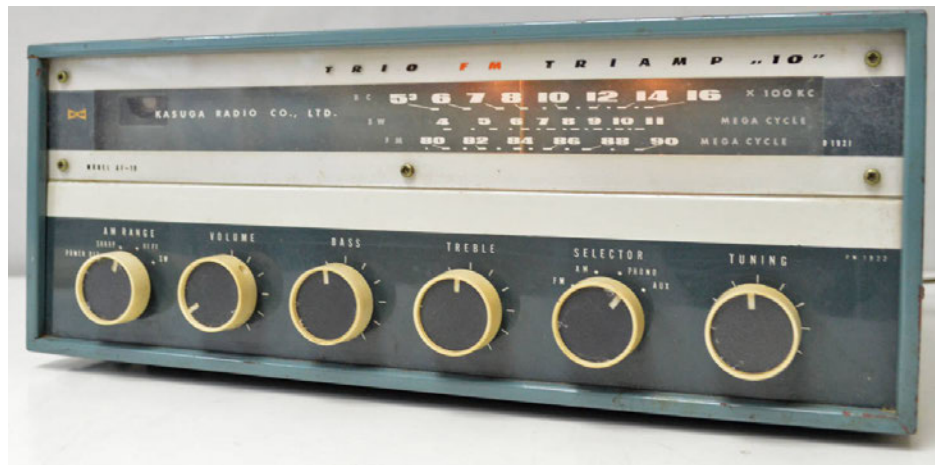
Vuonna 1958 julkaistu Trio AF10 viritinvahvistin oli radion osalta aikanaan erittäin edistysellinen. Sisältäen edistyneitä ominaisuuksia, kuten automaattisen taajuuden vakaajan (AFC), häiriönpoistopiirin ja korkeataajuusvahvistimen, jotka parantavat signaalin laatua ja vastaanottoa. Vahvistimen teho oli vaatimaton 10 wattia. Teknisesti laite käyttää elektroniputkia.
