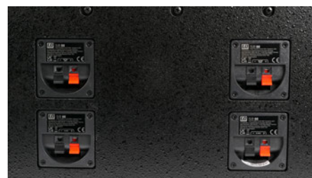
Passiiviversio liitetään normaalisti vahvistimeen ja subwooferista edelleen pääkaiuttimille. Liittimet voisivat kyllä olla astetta laadukkaammat.
