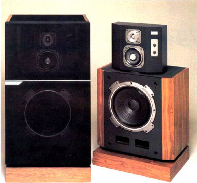
Kenwood LS-1900 edusti aikoinaan Kenwoodin parasta kaiutinosaa. Mallia valmistettiin vuosina 1980–1982. Kaiuttimessa on 330 mm bassoelementti, 130 mm keskiäänielementti ja painekammio-torvidiskantti. Sen toistoalueeksi ilmoitettiin 30–21 000 Hz ja herkkyudeksi 92 dB. Kaiuttimen mitat olivat 1050 x 560 x 450 mm ja paino 58 kg. Alkuperäinen hinta oli aikoinaan noin 6 000 Saksan markkaa parilta.
