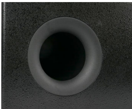
LD Systems 88:ssa on sisällä kaksi 8-tuumaista elementtiä vastakkain (ns. isobarik). Kotelo on 4-asteen eli suljettu kaistanpäästö (bandpass). Kaikki ääni tulee toisen kotelon refleksiaukosta.
