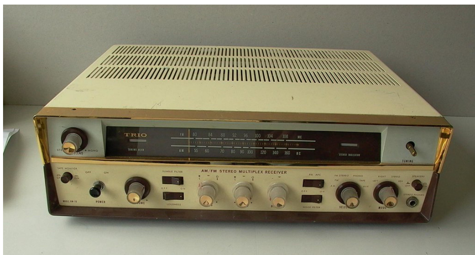
Trio KW-70 (1963), oli stereofoninen, mutta edelleen putkitekniikkaan perustuva AM/FM-vastaanotin. Se tarjoaa 25 watin jatkuvan tehon per kanava ja sisältää analogisen viritysnäytön sekä "magic eye"-ilmaisimet stereotilan ja virituksen näyttämiseen.
