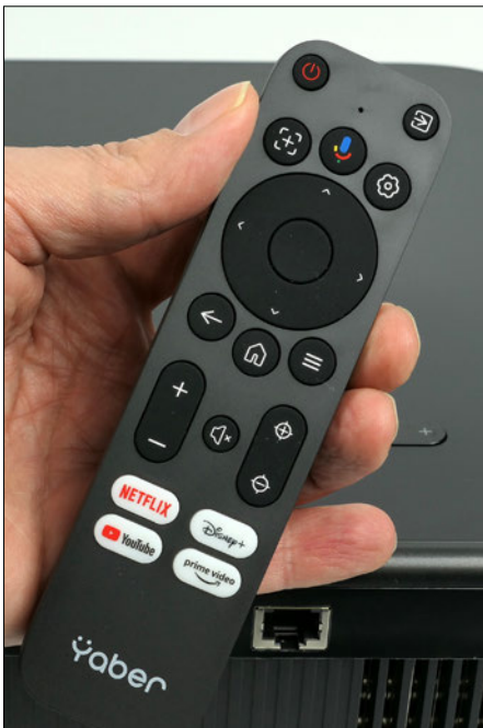
Kaukosäädin on selkeä ja siinä on painikkeet automaattiselle trapetsikorjaukselle ja tarkennukselle sekä suoravalinnat Netflix- ja Youtube-palveluihin.
