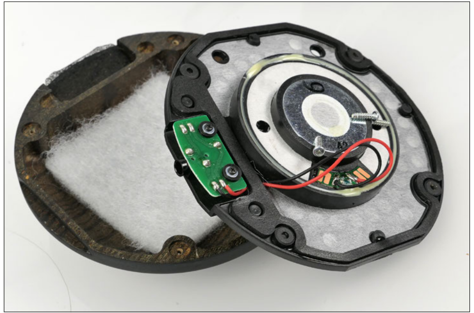
Denon AH-D5200:n akustiikka on rakennettu puisten kupprien pohjalta, millä voi hyvinkin vaikuttaa ääneneen.
