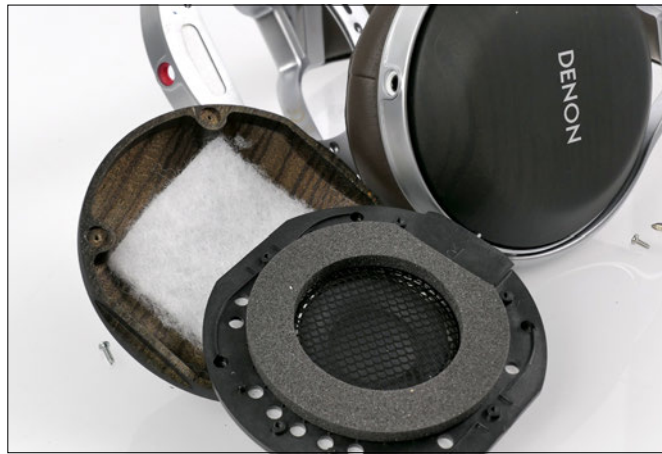
Denon AH-D5200:n akustiikka on rakennettu puisten kupprien pohjalta, millä voi hyvinkin vaikuttaa ääneneen.
