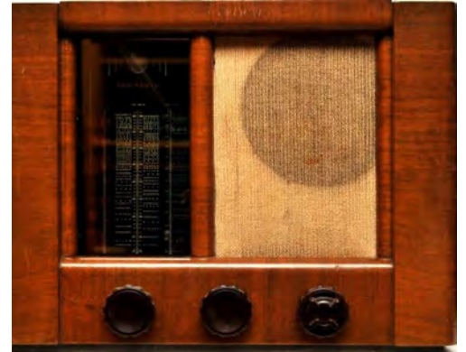
ASA 418 Y, valmistusvuosi 1939. 4+1+2-putkinen "super" vaihto-/tasavirtavastaanotin. "Taikasilmänäkö"-viritys
