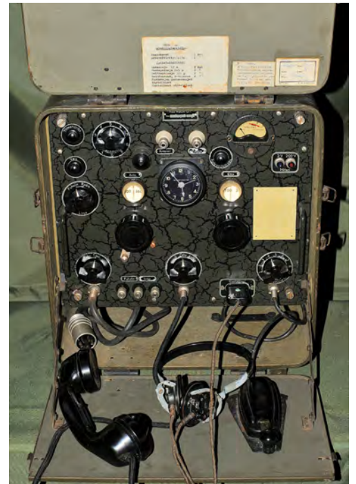
ASA 418 Y, valmistusvuosi 1939. 4+1+2-putkinen "super" vaihto-/tasavirtavastaanotin. "Taikasilmänäkö"-viritys
