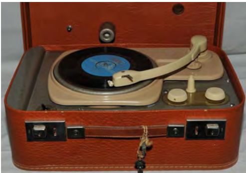
COSMOS IV, (1956). Kannettava levysoitin. Oma vahvistin ja kaiutin. 2-putkinen vahvistin.
