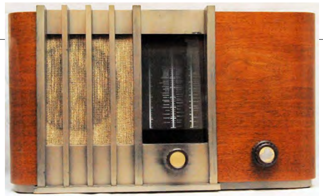
ASA 409, valmistusvuosi 1939. 4 + 1 - putkinen "loistosuper"-vaihtovirtavastaanotin. Hieno funkkis-desing.
