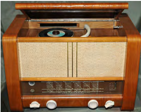
ASA 111, valmistusvuosi 1953. Sama radio kuin ASA 110 ja ensimmäisiä ULA-radiota. Tämä malli ASA 111 on varustettu Perbetuum-Ebner- levysoittimella.
