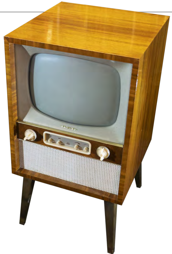
ASA TV 221/43 K, valmistusvuosi 1957. Ensimmäinen ASA RADIO Oy:n valmistama sarjatuotantotelevisio, konstruktio numero 1. Valmistusvuosi 1957, (ensimmäinen kappale valmistui 2.2.1957). (Tehtiin myös malleina L, lattia- ja P, pöytämalli). L ja P-mallia tehtiin yhteensä 110 kpl, K= Kaappimallia, valmistettiin 148 kpl. Kuvan koko (halkaisija) 43 cm = n. 17 tuumaa!
