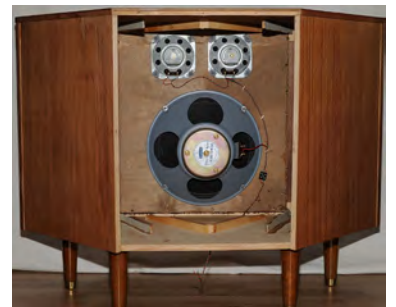
Valmistusvuosi 1957 (?). ASA vastaanottimien (1138(L) ja 1148(L) kanssa käytettävä "kovapuhujajärjestelmä", jossa bassopäällä laskostetun torvi. Elementteinä 1 kpl 12" Audiom 50 bassokovapuhuja sekä 2 kpl 4" diskanttikovapuhujia. Kaapin mitat: 95 x 70 x 38 cm
