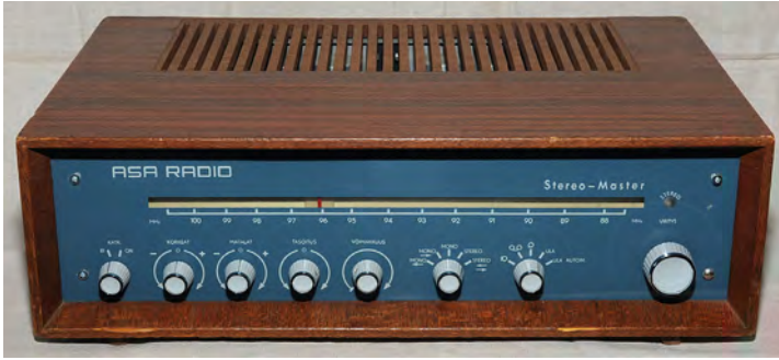
ASA siirtyi 60-luvulla stereo-aikaan. Kuvassa ASA 2481 T Stereo-Master, valmistusvuosi 1963. Täystransistoroitu ULA-stereoviritinvahvistin. Lähtöteho 2 x 10 W.
