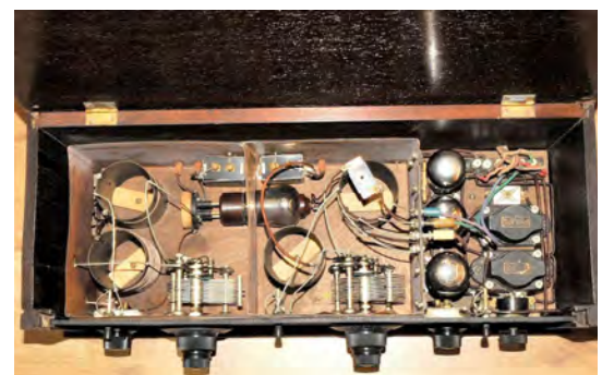
ASA 4 (valmistusvuosi 1929). Neliputkinen suojahilaputki radiovastaanottaja, niinkuin esitteessä aikoinaan kerrottiin. Tämän tarkkaviritteisen radiovastaanottajan rakentaminen kävi mahdolliseksi vasta sen jälkeen kun Philips- tehtaat toivat markkinoille uuden "IHMEPUTKEN", kuten tätä kutsuttiin, suojahilaputken A 442. Putken ominaisuuksista mainittakoon sen tavaton vahvistuskerroin. Se vahvistaa siihen johdetut sähkövärähdykset 150 kertaisiksi.
