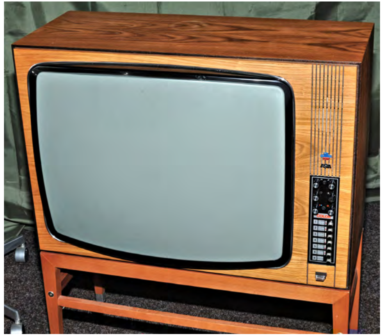
ASA TV CT 5004 A, valmistusvuosi 1970. 26-tuuman "super-suorakulmainen" värikuvaputki. Säätimet äänenvoimakkuutta ja -sävyä, kuvan sävykkyyttä ja -kirkkautta sekä värin sävyä ja kylläisyyttä varten. Kotelo teakia tai palisanteria
