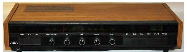
ASA 1000 Q, valmistusvuosi 1974. 2 x 20 W stereovahvistin, ularadio. Viritinvahvistin täyttää hifi-normin DIN 45.500. Vahvistimen jatkuva teho 2x12 W (!) Harmoninen särö alle 0,5 %/1 kHz. Toistoalue Äänenvoimakkuussäätimeen on yhdistetty "lineaarinäppäin", jolla fysiologinen toisto saadaan suoraviivaiseksi (Loudness-kytkentä). Kotelo pähkinää tai palisanderia.
