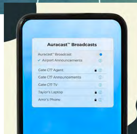
Bluetooth Auracast -toiminto mahdollistaa äänilähetysten jakamisen useille käyttäjille. Kuvassa näkyy esimerkki kanavalistauksesta, jossa käyttäjä voi valita mitä äänilähdettä kuuntelee
