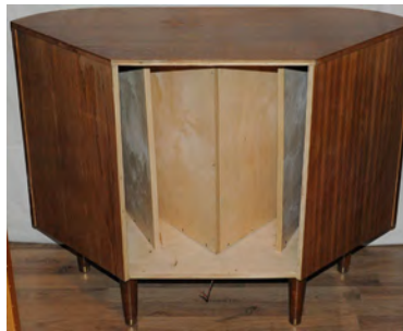
Valmistusvuosi 1957 (?). ASA vastaanottimien (1138(L) ja 1148(L) kanssa käytettävä "kovapuhujajärjestelmä", jossa bassopäällä laskostetun torvi. Elementteinä 1 kpl 12" Audiom 50 bassokovapuhuja sekä 2 kpl 4" diskanttikovapuhujia. Kaapin mitat: 95 x 70 x 38 cm
