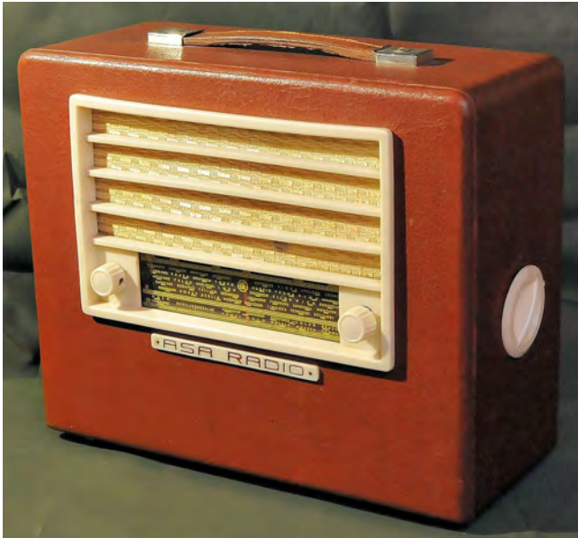
Superheterodyne kytketty verkkovirta/paristokäyttöinen matkaradiovastaanotin. Virtalähteet: Anodiparisto 80 V, A-80 super ja hehkupari Hp-7,5, tai vaihtovirtaverkko: 127, 220 V. 4 tuuman permanenttidynaminen kaiutin
