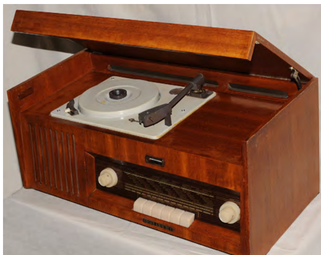
ASA 769 L, valmistusvuosi 1961. 5 +1- putkinen vaihtovirtavastaanotin, jossa Garrard SRP 10- levysoitin.
